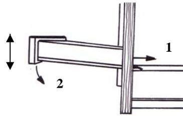
Blende durch lockern der Schrauben höhenverstellbar
